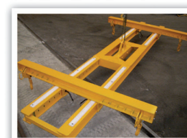
Palonnier cmu 2T, forme H avec réglage en X et Y
