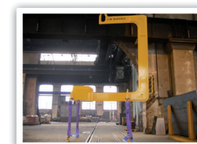
Cé de levage cmu 2T pour batterie élévateur
