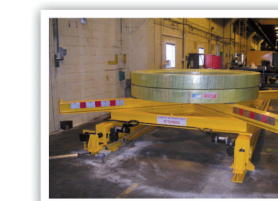
Chariot de transfert capacité 1 OT
