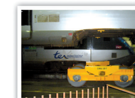
Faux bogie capacité 30T pour déplacement de caisse TER
