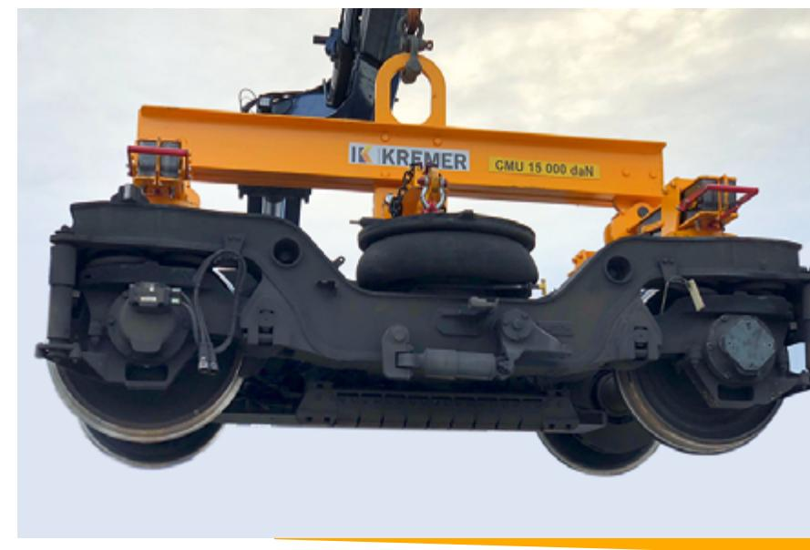
PALONNIER LEVAGE BOGIE RATP CMU 15 TONNES
