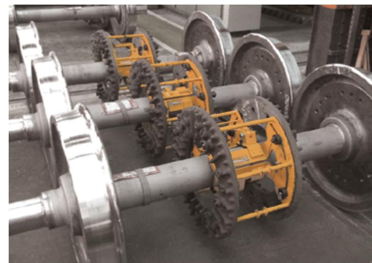
SUPPORT DE STOCKAGE DISQUE AGC SUR AXE D'ESSIEU
